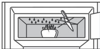
**Для оттаивания не использовать электрические нагревательные или пароочистительные приборы, шпрей для оттаивания, открытый огонь или металлические предметы для удаления льда. Опасность травмы и повреждений!**
