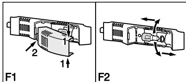
● Рис. F1: Возьмитесь за крышку лампы сверху и снизу и снимите ее.
